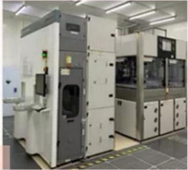
对12寸晶圆进行化学机械研磨。
